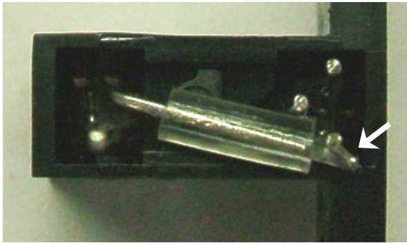
9. 飛び出たリードは切っておきます。また、熱収縮チューブは、ヒートガンやドライヤなどで縮めておきます。2 個作ります。
