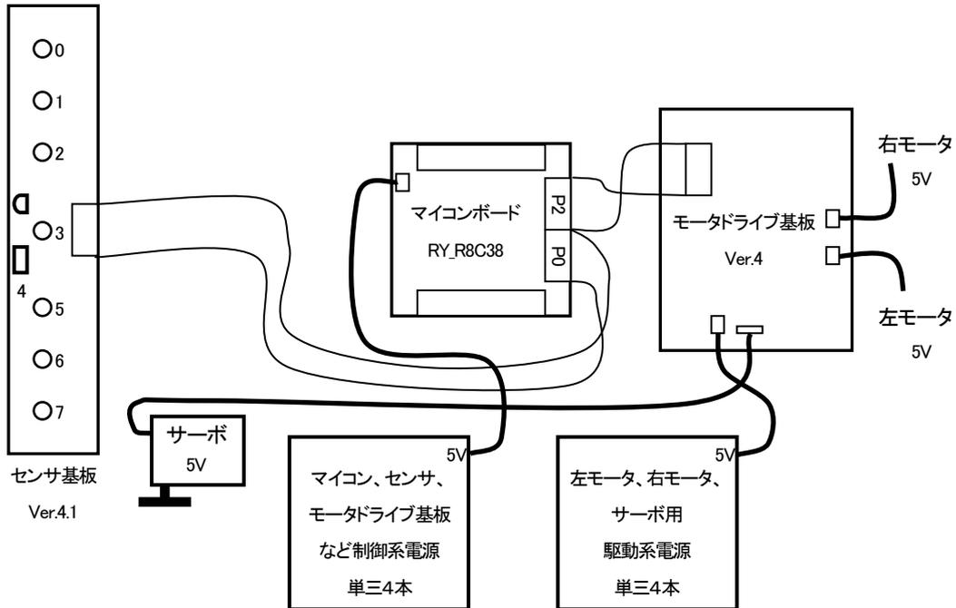
モータドライブ基板に「LM350 追加セット」を追加した構成のマイコンカーも、動作確認することができます。追加したときの構成を、下記に示します。
