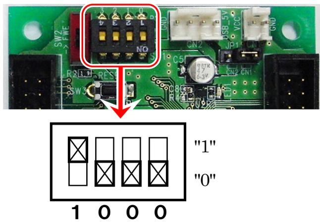
ディップスイッチを”1000”の状態に、マイコンカーの電源スイッチを2 つとも ON にします。
