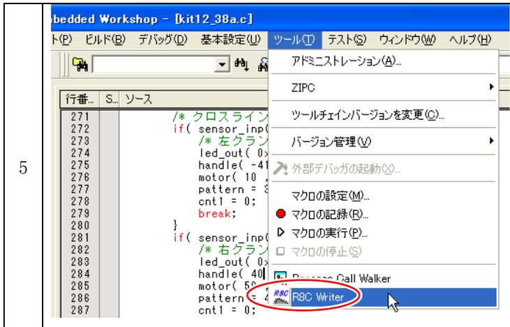
「ツール→R8C Writer」で R8C Writer を立ち上げ、プログラムを書き込みます。書き込み終了後、RY\_R8C38 ボードの電源を OFF にして書き込みスイッチを内側にしておきます。
