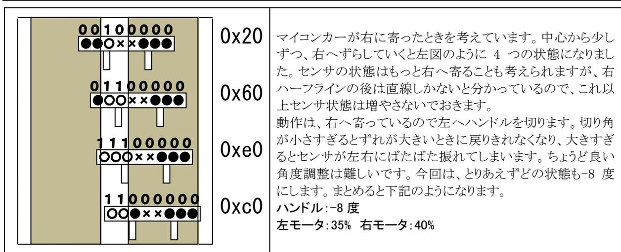
ポイントは、中心線があるかどうかのチェックは 8 個のセンサすべてを使用することです。他は「MASK3\_3」でマスクして中心の 2 個のセンサは使用しません。
