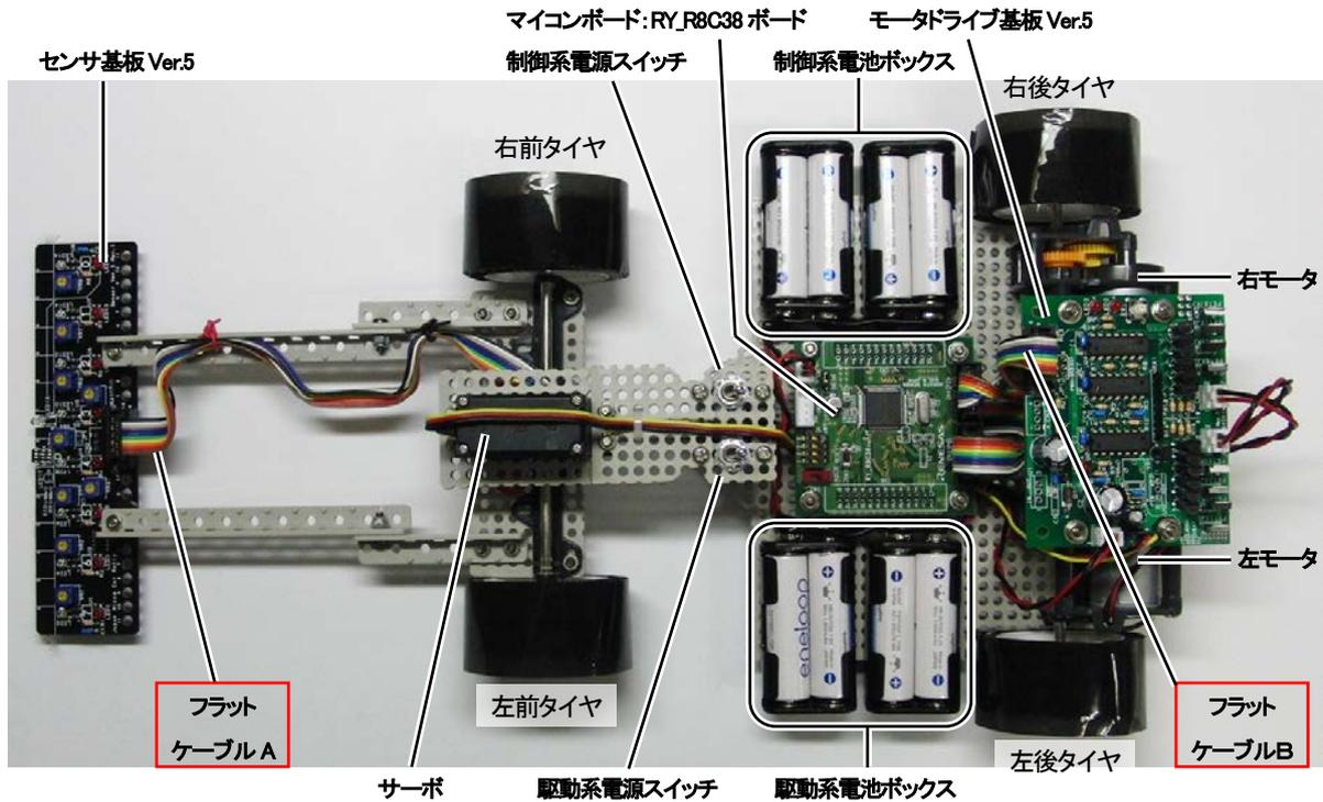
マイコンカーキット Ver.5.1 は制御系の RY\_R8C38 ボード(R8C/38A マイコン搭載のマイコンボード)、センサ基板 Ver.5、モータドライブ基板 Ver.5、駆動系の右モータ、左モータ、サーボで構成されています。
