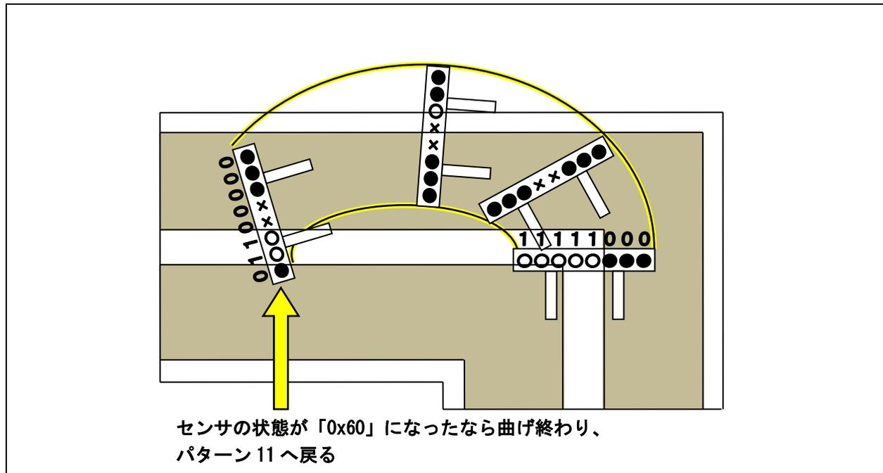
「0xf8」と判断すると左へ大曲げしますが、スピードがついているので脹らみ気味に曲がっていきます。センサが中心線付近に来て「0x60」になったときを曲げ終わりと判断してパターン 11 へ戻ります。
