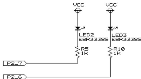
モータドライブ基板には3個のLEDが付いています。そのうち、2個がマイコンでON/OFF可能です。LEDのカソードは、マイコンのポートに直結されています。電流制限抵抗は、1kΩです。EBR3338Sは順電圧1.7V、電流は20mA流すことができます。電流制限抵抗は下記のようになります。
