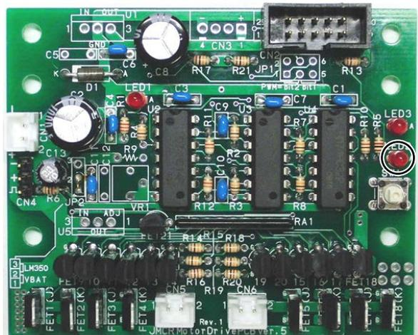
右ハーフラインを検出すると、モータドライブ基板の LED が 1 個点きます(下側)。点いていなければ、右ハーフラインを検出していません。右ハーフラインの検出がうまくできているか分からない場合は、モータのコネクタを抜いて、マイコンカーを手で押しながら進めて確かめてください。
