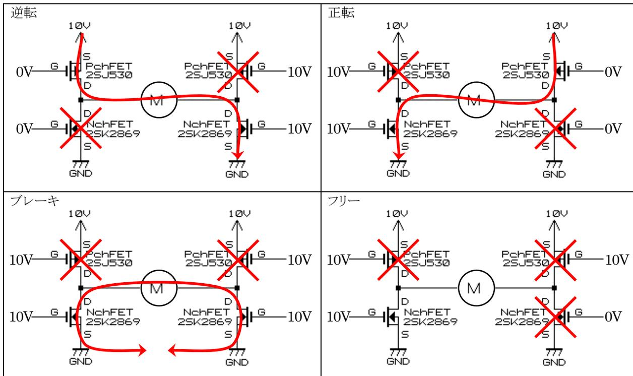
注意点は、絶対に左側2個もしくは右側2個のFETを同時にONさせてはいけません。同時にONにすると、10VからGNDへ何の負荷もないまま繋がりますのでショートと同じです。FETが燃えるかパターンが燃えるか…いずれにせよ危険です。
