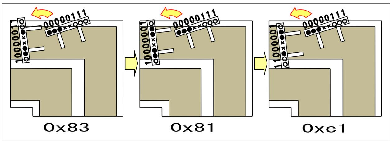
シミュレーションしてみます。0x07になると、「0x83か0x81か0xc1」になるまで曲げ続けます。そのため、「0x60」になっても曲げ続けます。前までは、ここで通常パターンに戻り脱輪してしまいました。その後、さらに曲げ続け「0x81」になると、0x60をチェックするプログラムへ戻します。その後センサが0x60の状態になると、中心線と判断して通常パターンに戻ります。
