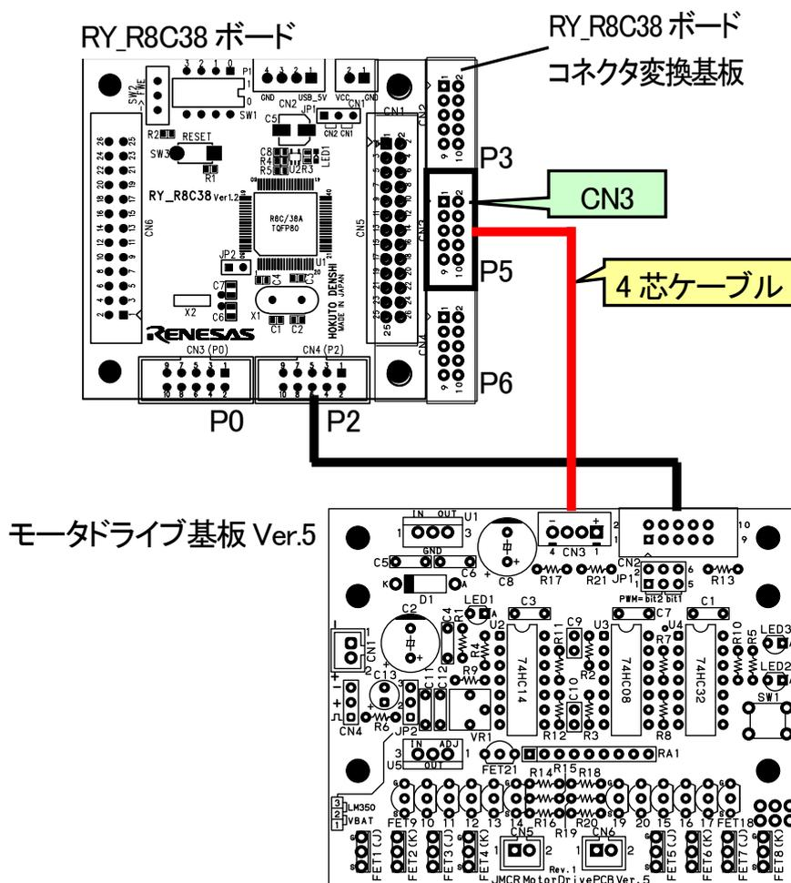
※「RY\_R8C38 ボードコネクタ変換基板」は、26ピンコネクタを10ピンコネクタ3個に変換する基板です。詳しくは、「マイコン実習マニュアル(R8C/38A 版)」を参照してください。
