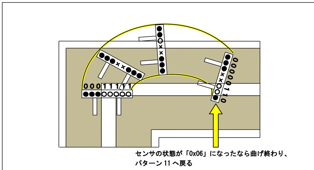
「0x1f」と判断すると右へ大曲げしますが、スピードがついているので脹らみ気味に曲がっていきます。センサが中心線付近に来て「0x06」になったときに曲げ終わりと判断してパターン 11 へ戻ります。
