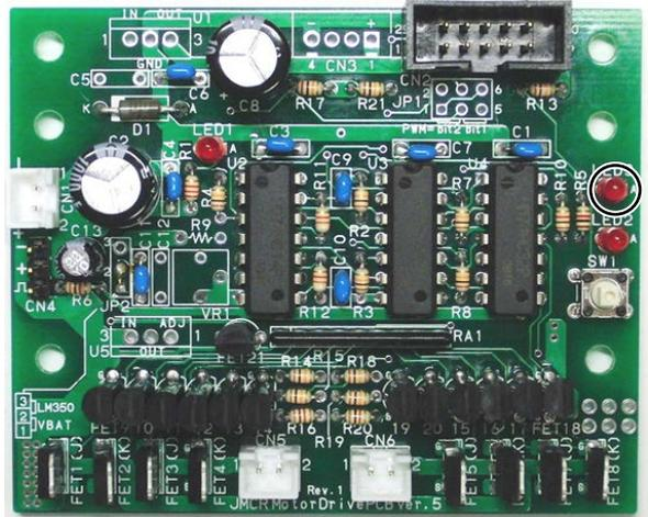
左ハーフラインを検出すると、モータドライブ基板の LED が 1 個点きます(上側)。点いていなければ、左ハーフラインを検出していません。左ハーフラインの検出がうまくできているか分からない場合は、モータのコネクタを抜いて、マイコンカーを手で押しながら進めて確かめてください。
