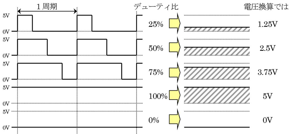
なぜ電圧制御ではなくパルス幅制御でモータのスピードを制御するのでしょうか。マイコンは”0”か”1”かのデジタル値の取り扱いは大得意ですが、何Vというアナログ的な値は不得意です。そのため、”0”と”1”の幅を変えて、あたかも電圧制御しているように振る舞います。これがPWM制御です。
