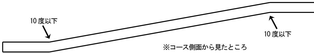
※車検は、上り下りコースパーツ部(10度以内の傾斜がついた坂道コースの一部)を使用して、マイコンカーを手動で通過させます。このとき、センサ類(タイヤ、アースを含む)以外はコースに接触してはいけません。
