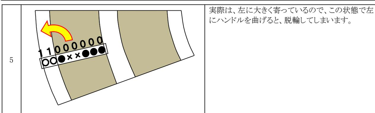
そこで、右に大曲げしたら、あるセンサ状態に戻るまで右に大曲げし続けるようにします。この“あるセンサ状態”を判定する部分を、パターン 12 に作ります。
