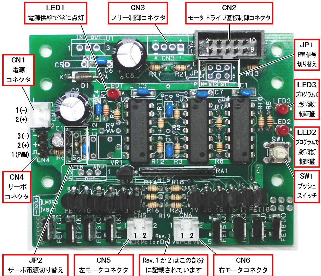
モータドライブ基板 Ver.5 のコネクタの接続先、信号の内容を下表に示します。
