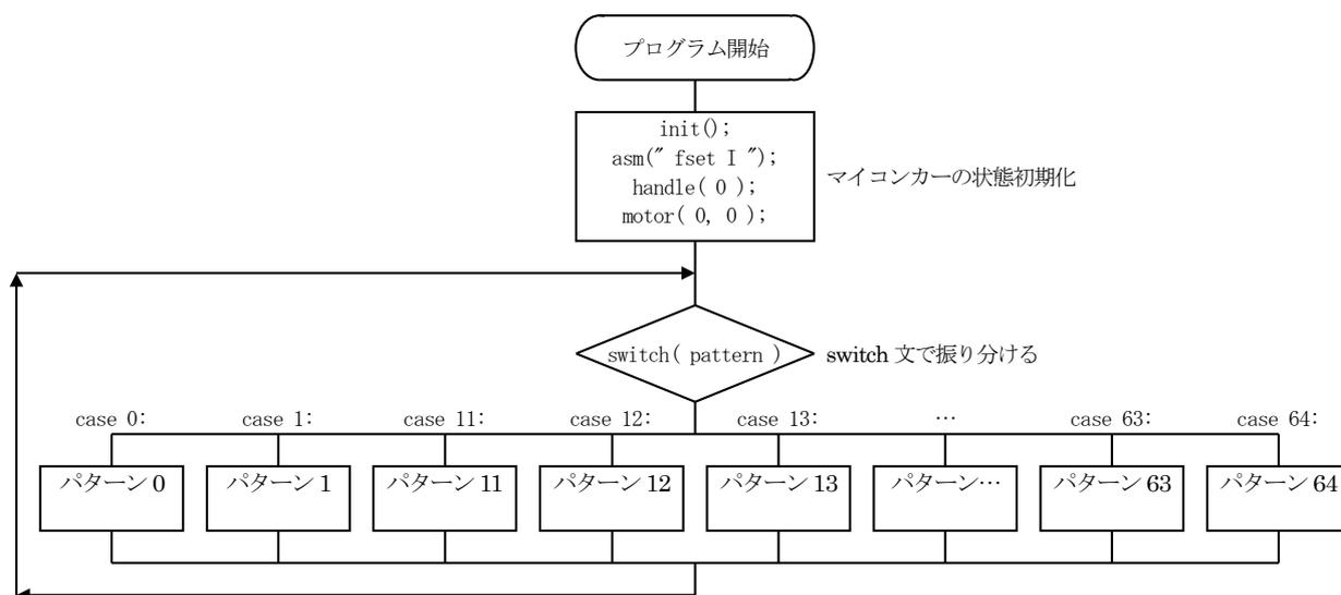
起動時、pattern 変数は 0 です。switch 文により case 0 部分のプログラム「パターン 0 プログラム」を実行し続けます。後ほど説明しますが、パターン 0 はスイッチ入力待ちです。スイッチが押されると、「pattern=1」が実行されます。フローチャートを下図に示します。
