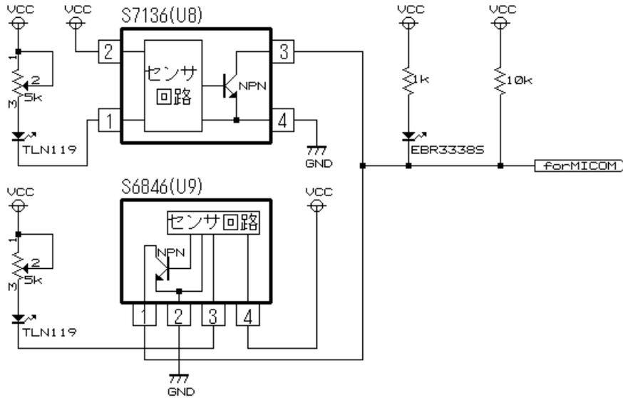
2 つのセンサの反応と、出力信号を下表に示します。
