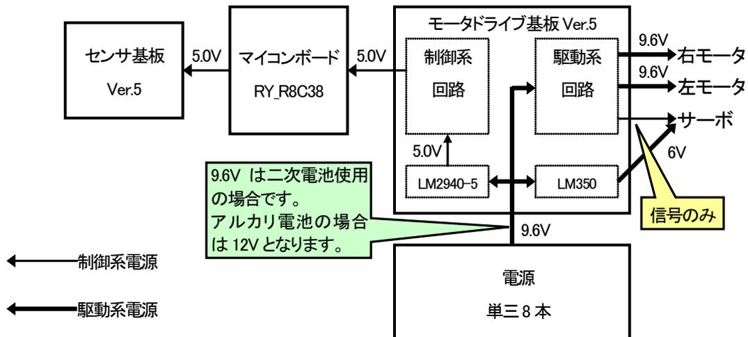
※キットの電池ボックスは、バネの押しが弱いので、マイコンカーの加減速によって、電池の端子が電池ボックスから離れてしまい電源が切れて、マイコンがリセットすることがあります(数十msの単位です)。押しつけの強い電池ボックスを使うなどして、このようなことが起こらないようにしてください。
