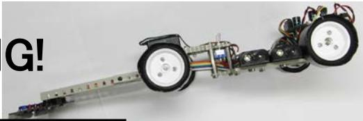
このように、手で持ちながらセンサの調整をしようとしてもセンサとコースとの間隔が一定にならないため、きちんと調整できません。必ずコース同一面上に置いてください。
