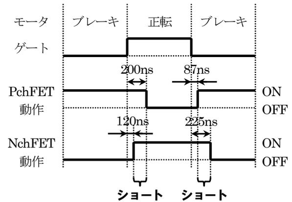
ONしてから実際に反応し始めるまでの遅延を「ターン・オン遅延時間」、ONになり始めてから実際にONするまでを「上昇時間」、OFFしてから実際に反応し始めるまでの遅延を「ターン・オフ遅延時間」、OFFになり始めてから実際にOFFするまでを「下降時間」といいます。
