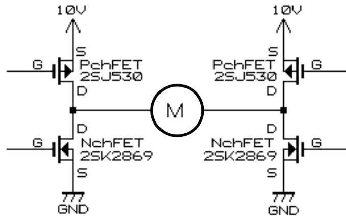
これら4つのFETのゲートに加える電圧を変えることにより、正転、逆転、ブレーキの動作を行います。
