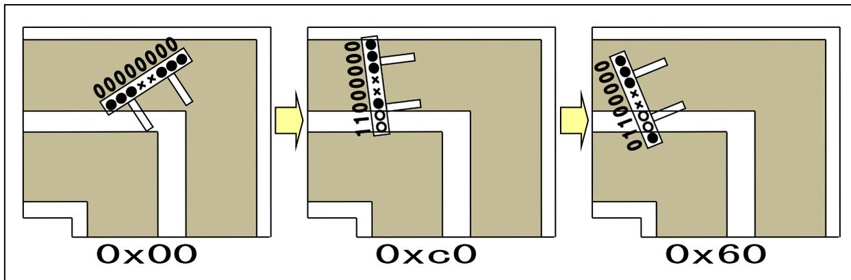
外側の白線を中心と勘違いしたときのセンサの移り変わりを確認します。0x07→0x00→0x60 のようにセンサの状態が変わり、通常走行に戻ります(下図)。
