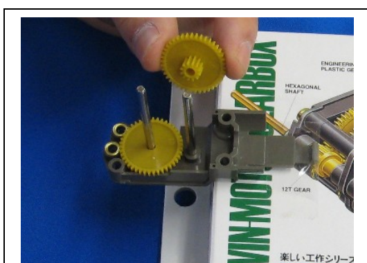
5. シャフトに G2 ギヤをセットします。
