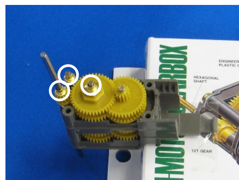
20. ハトメの突起部分を上向きにして、3か所にセットします。
