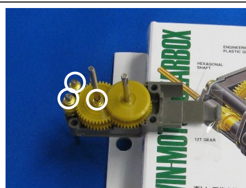
10. ハトメの突起部分を上向きにして、3か所にセットします。
