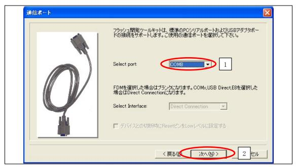
「3.5 COM ポートの確認」で確認した COM ポートを選択し、「次へ」をクリックします。
