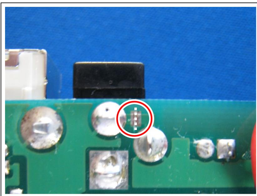
DC ジャックを半田付けした場所のそばに、銀色の四角い部分がありますので、そこをカッターなどでカットして分離させます。他の部分をカットしてしまわないように、気をつけてください。
