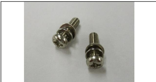
写真のように、なべネジにスプリングワッシャ、平ワッシャの順で入れたネジを 2 個作ります。
