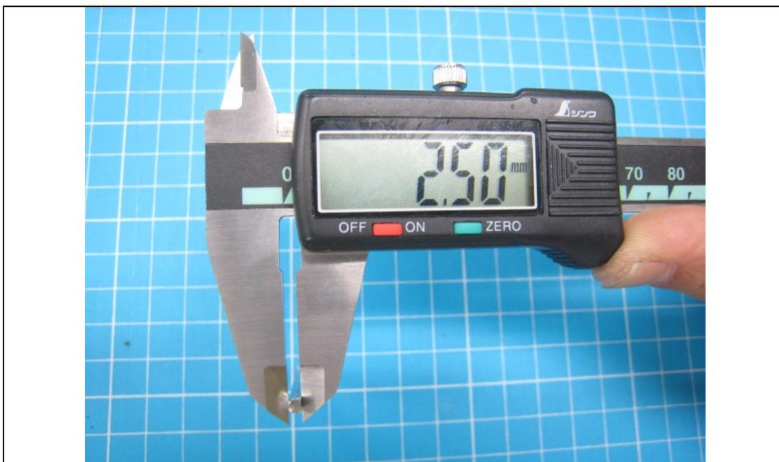
D カットの寸法は 2.50mm 程度で仕上げます。ポテンショメータの穴のサイズ丁度になるように調整してください。隙間が空いてガタつくようであれば、紙などで埋めてください。
