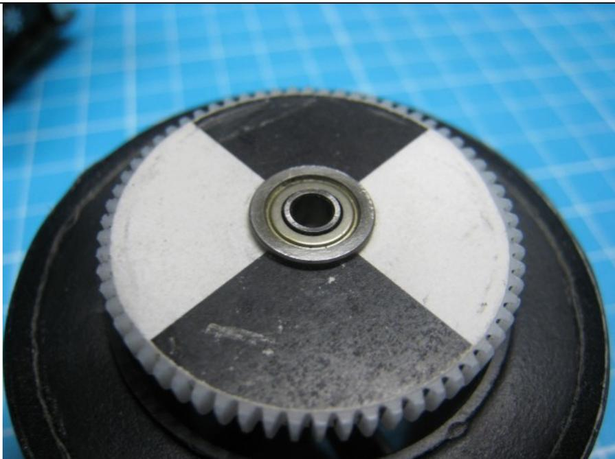
エンコーダーのディスクを印刷して貼り付け、シリコンシートを巻きます。
