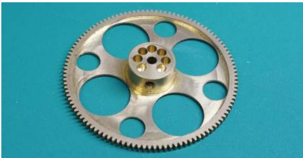
110T ギヤは重いので、軽量化するとステアリング部分の動きが良くなります。軽量化例を写真に示します。
