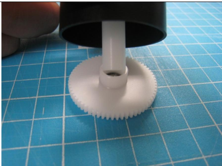
M4 ジュラコンスペーサ 25mm の先端の表面に接着剤を付けておき、64T ギヤに圧入します。
