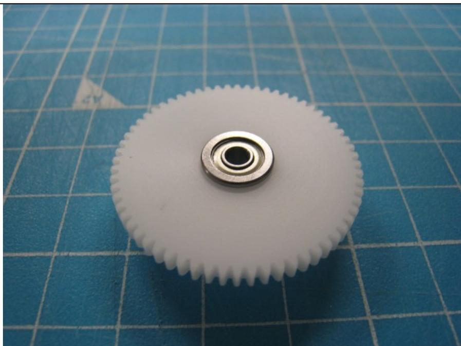
64T ギヤにベアリングを圧入します。
