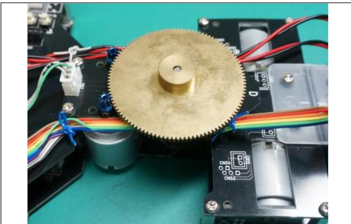
8T ピニオンギヤを2個、110T ギヤをいもねじで止めます。
