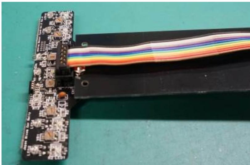
アナログセンサー基板 Ver. 2 用ケーブルの 10 ピン BOX コネクタメスを、アナログセンサー基板 Ver. 2 に取り付けます。
