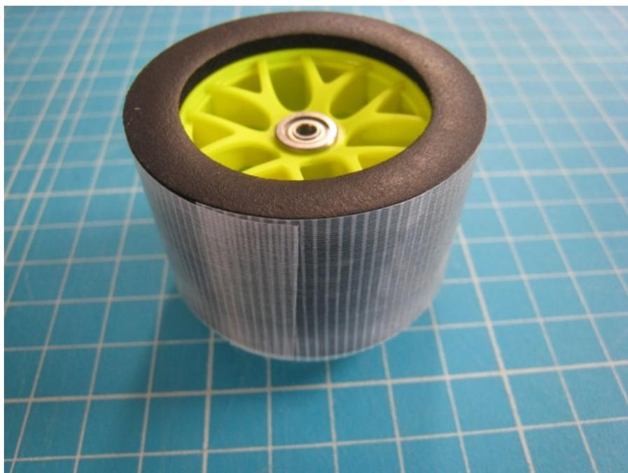
これから貼り付けるシリコンシートの交換がしやすいように、スポンジ表面に養生テープを巻きます。その後、シリコンシートを貼り付けます。
