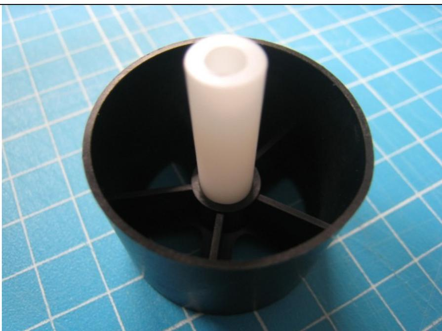
M4 ジュラコンスペーサ 25mm の先端の表面に接着剤を付けておき、ホイールに圧入します。
