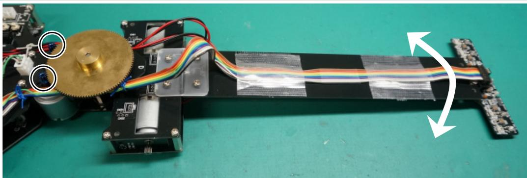
○部分の 8T ピニオンギヤを押さえて動かないようにして、センサーを左右に動かします。アナログセンサー基板 TypeS Ver.2 の動きの幅が 5mm 以上の場合、再度調整をやり直してください(ガタが無いのが理想です)。
