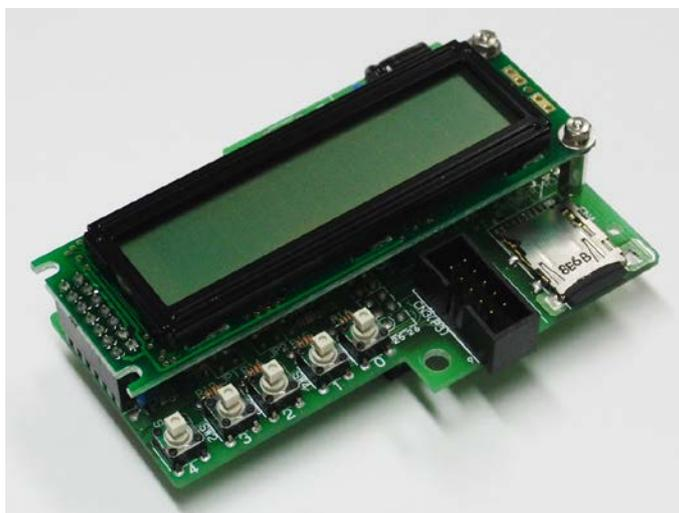
▲液晶・microSD 基板(完成例)
