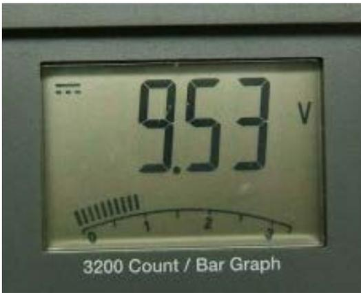
A digital voltmeter with a green display showing 9.53 V. Below the display is a bar graph with 10 segments and the text "3200 Count / Bar Graph". | <p>電圧は 9.53V です。このままサーボを繋ぐと壊れます。ボリュームで電圧を調整をします。</p> |
