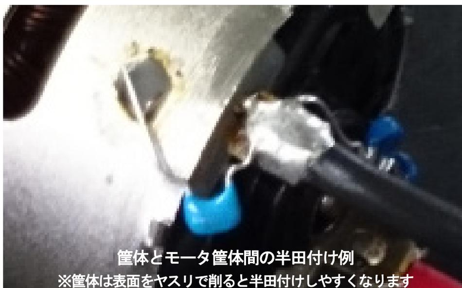
それでもモータを回したときにリレーが誤動作するときは、全モータの筐体間を線で結び、その結んだ線をリレー基板の GND とロボットのシャーシに繋いでください。
