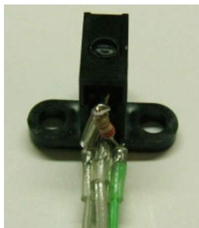
10. 熱収縮チューブを、フォトインタラプタの根本まで下ろします。
