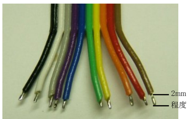
12. 片側は、約 2mm 被覆を剥いて、半田上げしておきます。半田上げとは、予め線に半田を付けておくことです。
