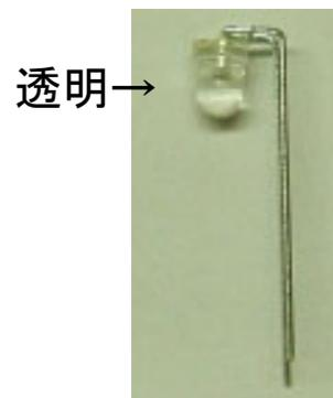
5. 写真のように下に 90 度曲げます。A 側、K 側両方とも一緒に曲げます。
