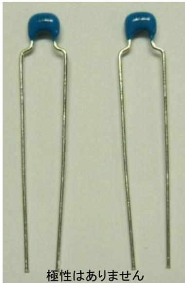
1. 積層セラミックコンデンサを2個用意します。「104」と書いてありますので、書いてある方を外側に向けて後でコンデンサの容量を読むときに見やすくなります。ちなみに、「104」とは、 $10 \times 10^4$  [pF] = 100,000 [pF] = 0.1 [  $\mu$ F ] となります。
