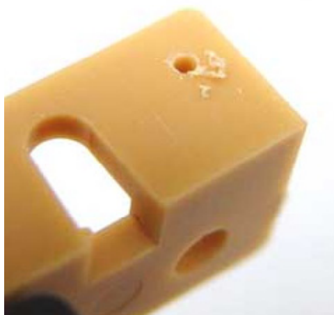
1mm の穴が開いたら、3mm に広げます。プレートを密着させたまま穴あけをするほうが、ずれが少なくなります。
